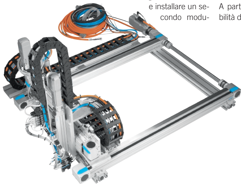
Esempio di posizionatore/manipolatore tridimensionale Festo completo. Progettato con il cliente, può
