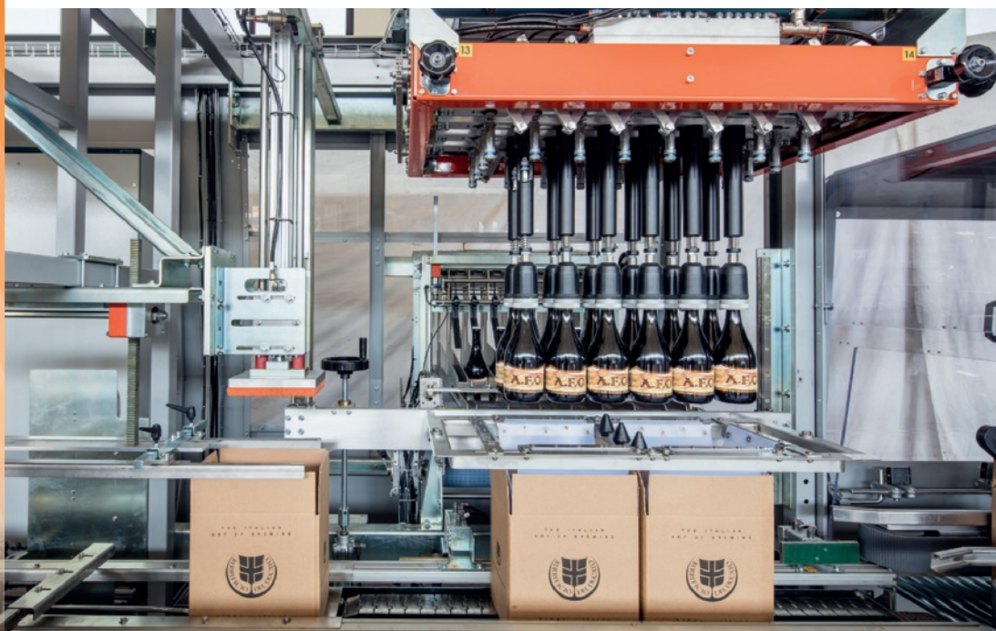
Linea automatica di preparazione di cartoni con bottiglie, realizzata da Fipal.
